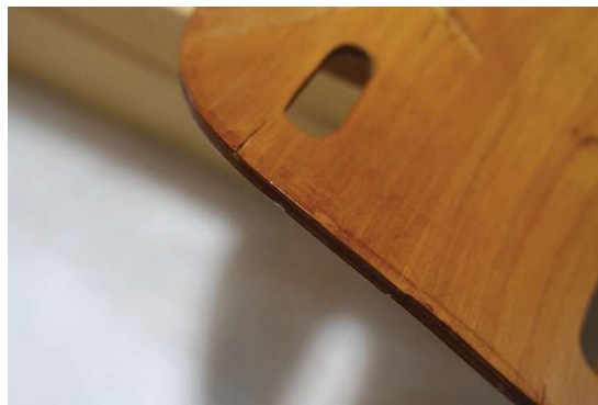
Fig. 6 Local edge crack-like line / 端部の局所的亀裂状線
