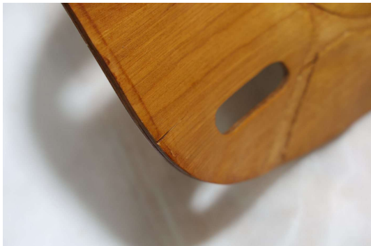
OM-PD-LS-001-P084 局所亀裂・接合部近傍（拡大 6） Localized crack near a joint (close-up 6) Source: 0R9A0092(1).JPG
