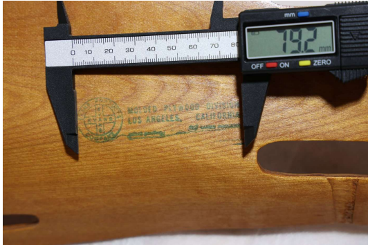
OM-PD-LS-001-P078 製造者刻印の幅計測 (方向違い 5) Manufacturer-stamp width measurement (angle 5) Source: 0R9A0086.JPG
