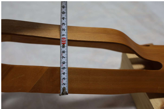
OM-PD-LS-001-P107 最大高さ計測・約 108 mm (方向違い 3) Maximum-height measurement, approx. 108 mm (angle 3) Source: 0R9A0158.JPG
